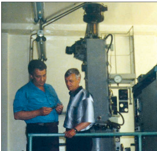
В.С. Кисельов (ліворуч) та С.Ф. Авраменко проводять вирощування монокристалів карбїду кремнію модифікованим сублімаційним методом за T = 2600\text{ }^{\circ}\text{C} із застосуванням модернізованої промислової печі РЕДМЕТ-30. 2003 р.
