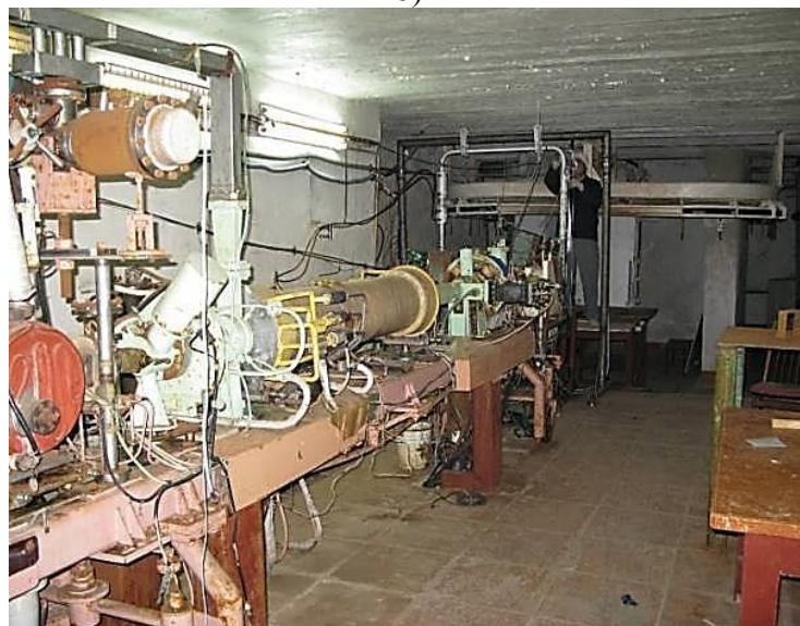
Рис. 2. Блочна схема надкритичної водної конвекційної петлі (НВКП) (а) та її розміщення у бункерній кімнаті лінійного прискорювача електронів ЛПЕ-10 (б)
